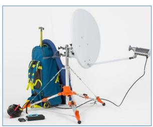
Мобильная абонентская земная станция спутниковой связи «SkyKit» является переносной станцией оперативного развертывания.
